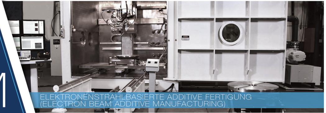
ELEKTRONENSTRAHLBASIERTE ADDITIVE FERTIGUNG
