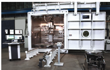
SCIAKY的 EBAM 110 系统 3D 金属打印机
